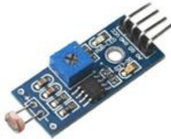
Hình 1.2: Cảm biến ánh sáng (LDR)
