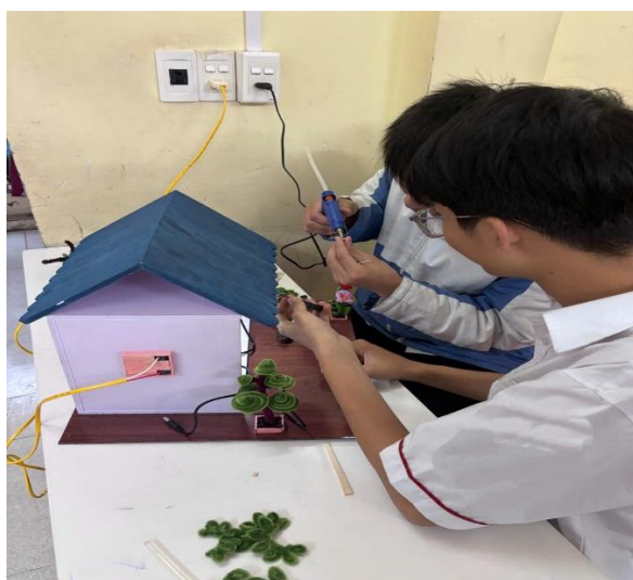
Hình 1.7 Lắp đặt cảm biến ánh sáng và nhiệt độ
