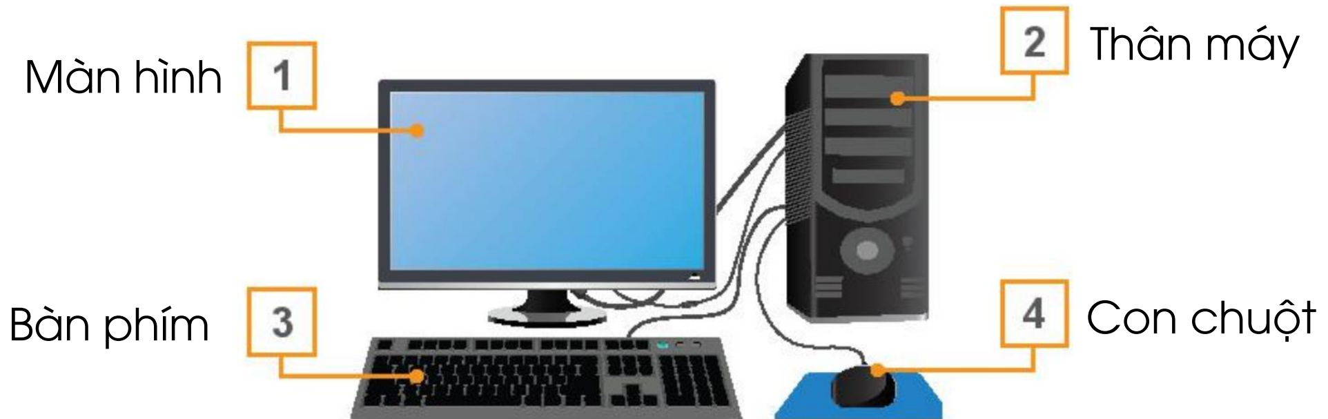
Hình 8. Các bộ phận cơ bản của máy tính để bàn
