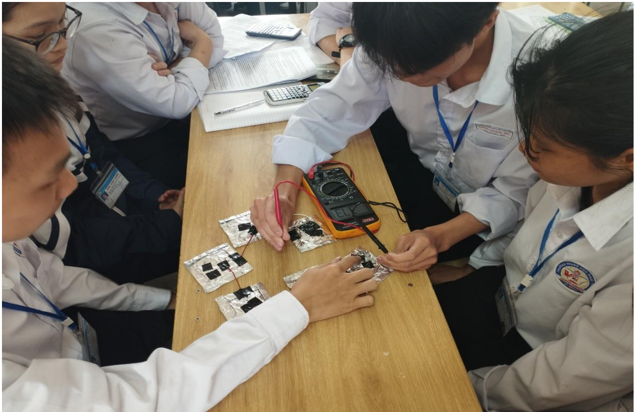
Đo hiệu điện thế tạo ra bởi các viên pin mắc nối tiếp
