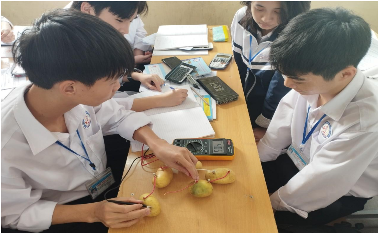
Đo hiệu thế tạo bởi 5 củ khoai tây được mắc nối tiếp
